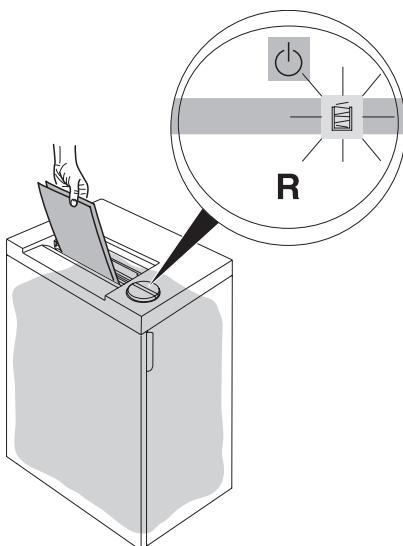
**RU** При заполнении пластикового мешка аппарат остановится автоматически. Должен загореться индикатор "мешок заполнен". Замените пластиковый мешок. (смотри стр. 9).
